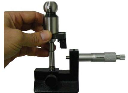
7. Aproximar o gume da pastilha na ponta de contato do micrômetro, utilizando o parafuso de regulagem do porta-pastilha.
