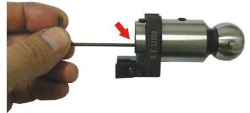
6. Por o mandril bola montado com a ferramenta de corte no aparelho.
