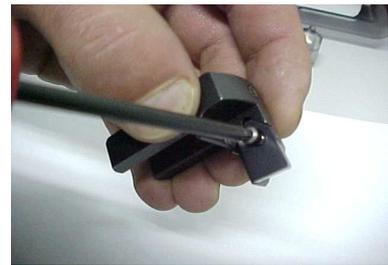
2. Monta-se o porta-pastilha no mandril bola e encosta-se os parafusos de fixação que se localiza no próprio mandril.
