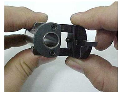
3. Zerar o micrômetro na haste do aparelho. A Haste tem 10mm de diâmetro, ou seja, zerando o micrômetro na haste, a medida partira de 10mm no diâmetro.
