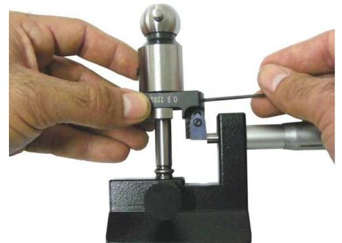
8. Girando o mandril bola de um lado para o outro, encostar de leve o gume da pastilha na ponta de contato do micrômetro e aperte os parafusos de fixação do porta pastilha.
