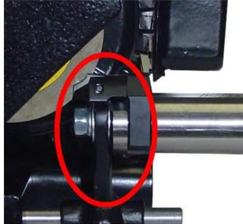
4- Não deixar o rebolo encostar no parafuso de fixação da pastilha.
