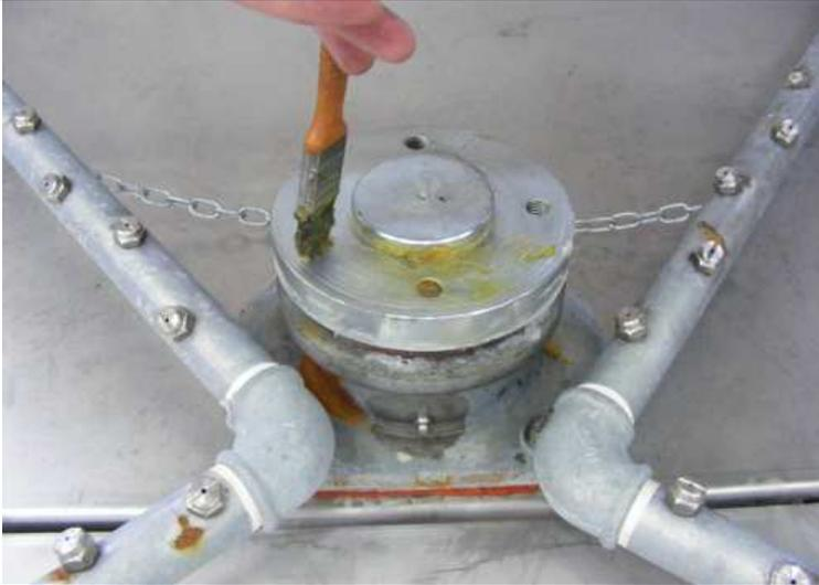
**Na** montagem do cesto lubrifique bem as partes com graxa.
