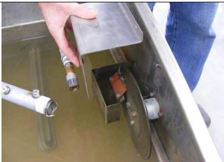
**Retire** a proteção do coletor de óleo e limpe seu reservatório, removendo todo o óleo e a graxa velha.
