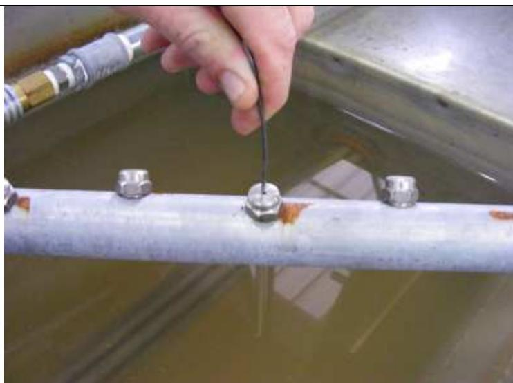
**Passe** uma agulha em todos os bicos empurrando a sujeira para dentro do cano.
