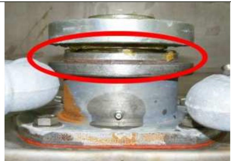
**Coloque** graxa até o ponto em que ela comece a fluir pelo retentor superior que é montado invertido, expulsando a graxa velha de dentro do cubo.
