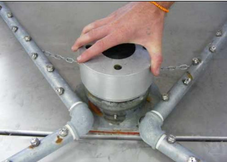
**Coloque** a capa do cubo no seu lugar e lubrifique também os parafusos de fixação do cesto.
