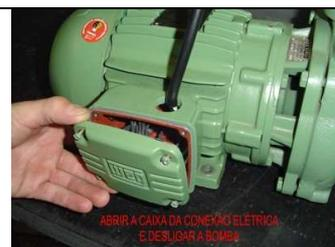
04- Soltar os cabos de alimentação do motor, marcar a posição dos fios para quando alimentar novamente o motor girar no mesmo sentido.(Horário)
