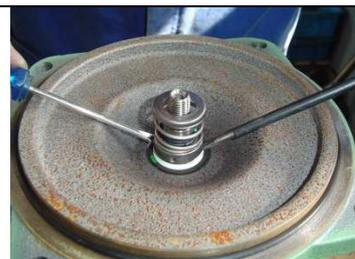
18- Com uma chave de fenda remova o anel cerâmico com a capa de borracha.
