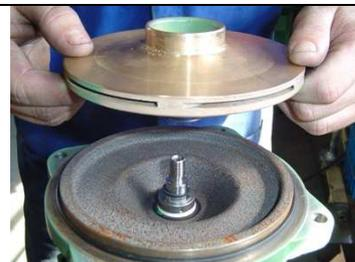
16- No eixo se encontra o selo mecânico. Arruela de assento, mola, retentor de viton, anel cerâmico e capa de borracha.
