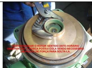
15- Remover o rotor do eixo do motor.
