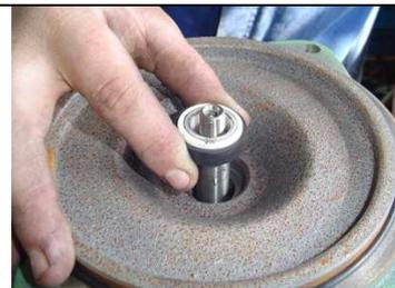
20- Para colocar o anel cerâmico novo no lugar passe um pouco de vaselina na capa de borracha e com um batente coloque o anel com cuidado para não danificar ou trincar o anel cerâmico.
