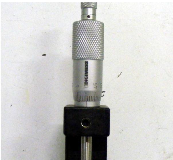
Para zerar a base, posicione o ZERO do tambor sobre a linha ZERO do micrômetro.
