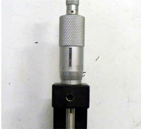
Ajustar novamente o micrômetro em zero.
