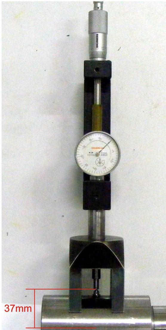
Agora o raio é de 37mm mais os 25mm de abertura do micrômetro teremos uma abertura máxima de 62mm que multiplicado por 2 teremos um diâmetro máximo de  $\varnothing 124\text{mm}$ .
