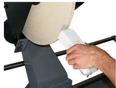
Quando finalizar o polimento em um dos colos do virabrequim, leve o feltro totalmente para traz até desligar o motor, movimente o carro para o próximo colo a ser polido e puxe o feltro para frente.
