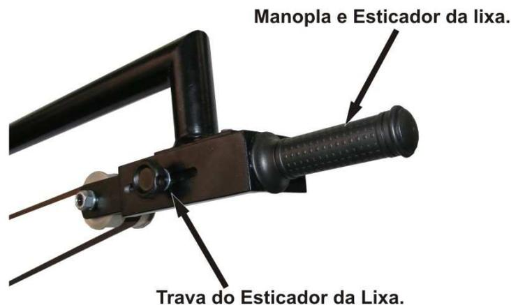
Para por a lixadeira em operação ligue a placa e selecione **LIXADEIRA** na comutadora, a luz verde deve acender, porém o motor só irá funcionar quando a lixadeira for avançada para frente e irá parar de funcionar quando for totalmente recuada para traz.
