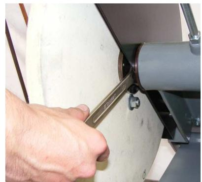
Montar o Disco com uma arruela pro lado de dentro e outra por fora, verificar lado do flange do feltro, cabeças do parafusos allen para fora. **ATENÇÃO:** Para melhorar a qualidade do polimento, balancear o disco de feltro
