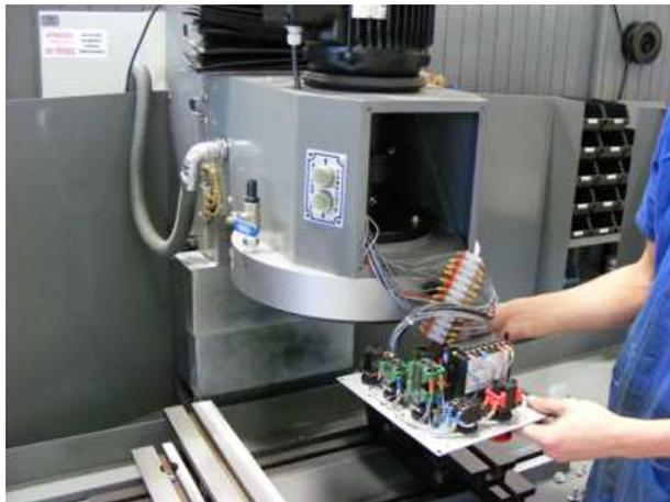
Não é necessário desligar a fiação elétrica.
