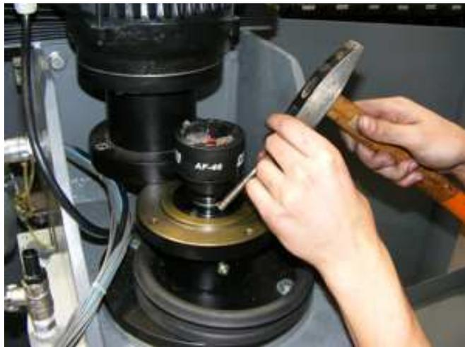
Em alguns modelos a porca possui um furo em sua superfície para ajustar batendo com um pedaço de ferro. Outros modelos a um encaixe de chave.
