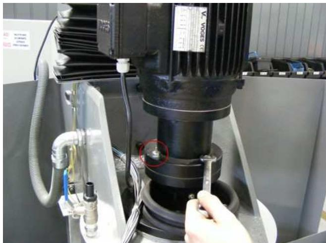
Soltar os parafusos do acoplamento do motor.
