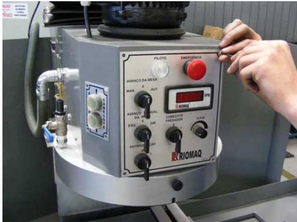
Primeiro passo posicionar o cabeçote a uns 200mm da mesa, desligar a chave geral da máquina.
