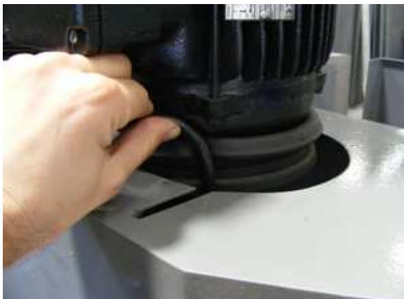
Não é necessário desligar o motor, basta por o cabo de ligação para o lado.
