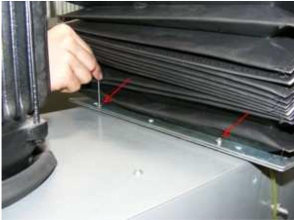
Soltar a proteção sanfonada da tampa de inspeção do cabeçote.
