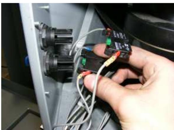
Retirar o dois blocos, mas não se esqueça de marcá-los para não inverter o de cima com o de baixo.
