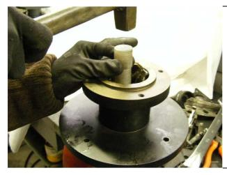
Utilizar um batente de nylon ou madeira para retirar o eixo, apoiando o cubo sobre uma morsa.
