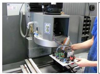
Não é necessário desligar a fiação elétrica.
