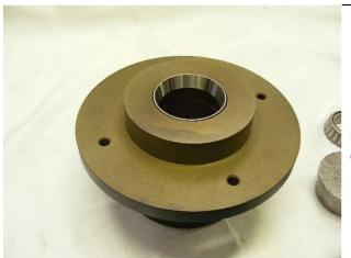
Na montagem lavar bem o cubo, montar as capas do rolamento, o eixo a capa.
