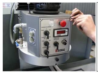
Próximo passo posicionar o cabeçote a uns 200mm da mesa, desligar a chave geral da máquina.
