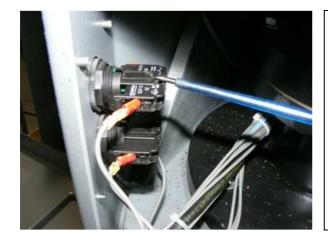
Retirar o bloco de contato do botão, com uma chave de fenda pequena levanta-se a trava do botão.
