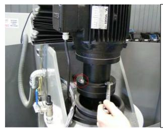
Soltar os parafusos do acoplamento do motor. Chave de boca 9/16 ou 14mm 04- Parafusos 3/8
