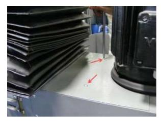
Retirar a tampa de inspeção do cabeçote. Chave Allen 1/8. 02- Parafuso Allen 3/16.
