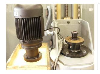
Coloque com cuidado o conjunto ao lado do cabeçote sobre a mesa de trabalho da máquina, coloque uma caixa de madeira para elevar o conjunto, assim não será preciso desligar o motor.
