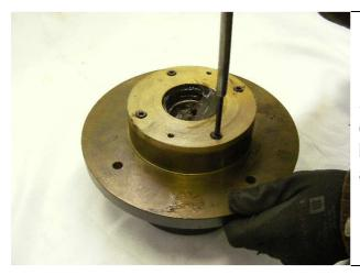
Soltar os parafusos da tampa do cubo. Nela se aloja o retentor, lavar bem essa peça e montá-la logo após montar o rolamento.
