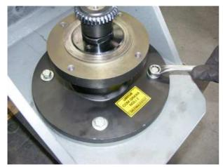
Soltar os parafusos de fixação do cubo.
