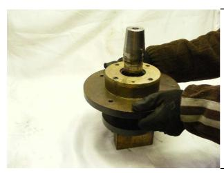
Bater o eixo para que ele saia do rolamento de trás. (Na foto eixo cônico)
