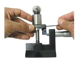
8. Girando o mandril bola de um lado para o outro, encostar de leve o gume da pastilha na ponta de contato do micrômetro e aperte os parafusos de fixação do porta pastilha.
