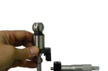
7. Aproximar o gume da pastilha na ponta de contato do micrômetro, utilizando o parafuso de regulagem do porta-pastilha.
