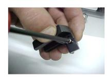
2. Monta-se o porta-pastilha no mandril bola e encosta-se os parafusos de fixação que se localiza no próprio mandril.
