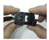
3. Zerar o micrômetro na haste do aparelho. A Haste tem 10mm de diâmetro, ou seja, zerando o micrômetro na haste, a medida partira de 10mm no diâmetro.
