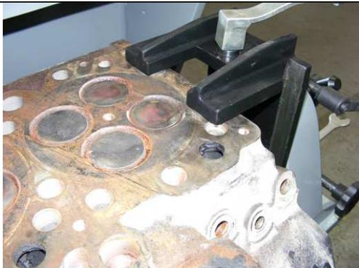
FIXADO SOBRE AS PORCAS A ESPAÇO SUFICIENTE PARA TRABALHAR COM A FERRAMENTA DE CORTE.
