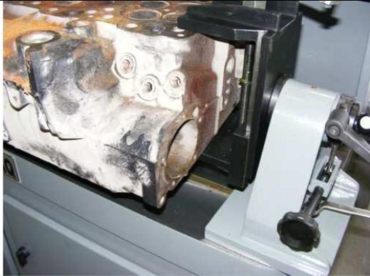
VISTA DA FACE DO CABEÇOTE, A MORSA APERTA SOBRE AS PORCAS DE FIXAÇÃO DOS CALÇOS.
